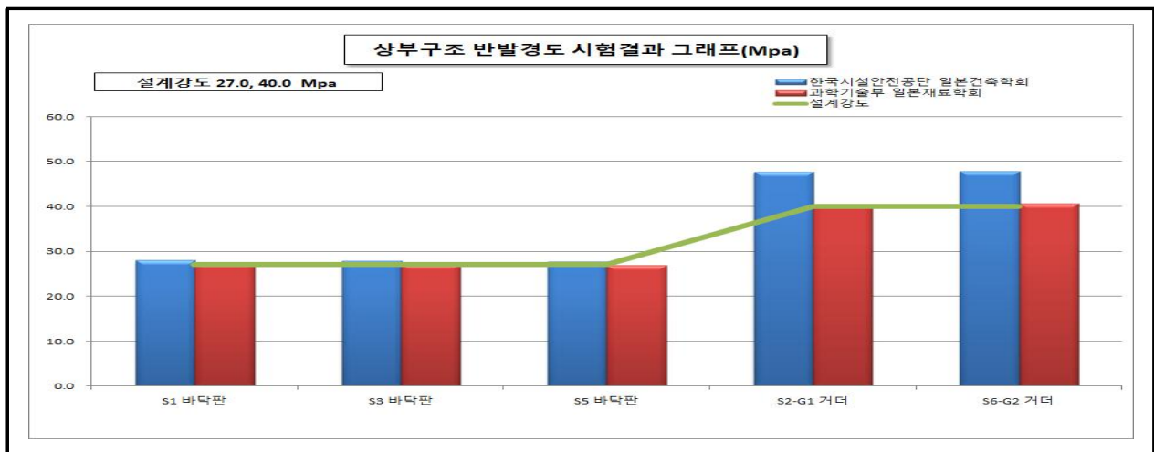
【그림 13.4.5】 영천방향 상부구조 반발경도시험 측정결과
