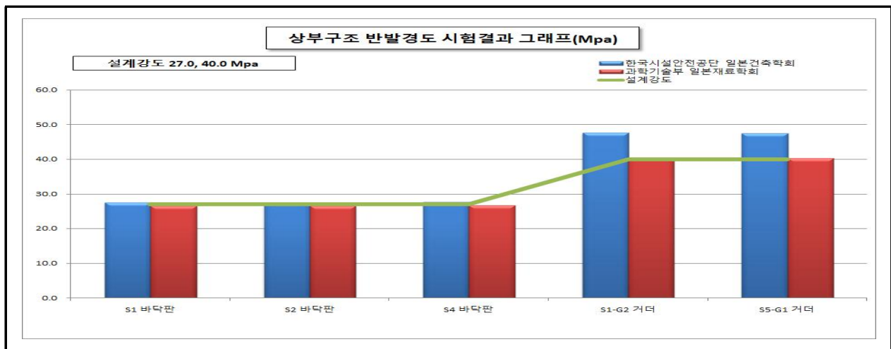
【그림 13.4.3】 상주방향 상부구조 반발경도시험 측정결과
